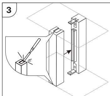
3 Fissare il secondo listello alla piastra di montaggio. Il materiale in eccesso deve essere precedentemente rimosso con uno scalpello. Utilizzare i morsetti per il fissaggio.
