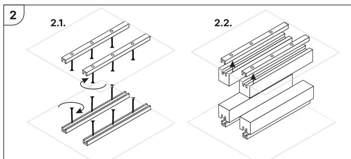
Assemblare la base superiore e inferiore.
