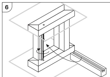
6 Fissare la parete al soffitto e al pavimento, utilizzando i punti di fissaggio che abbiamo precedentemente fatto. Rimontare il listello.
