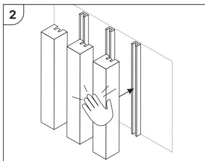
Fissare le lamelle alle piastre di montaggio.
