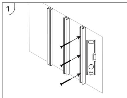
Fissare le strisce di montaggio su una parete pulita e piana.
