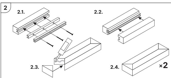
2 Assemblare la base superiore e inferiore.
